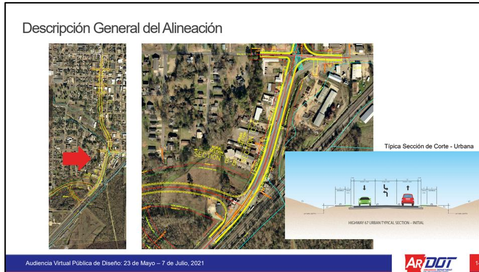
La sección típica corte tendrá dos carriles de circulación y un carril de giro central con bordillo y cuneta, acera y zanjas abiertas detras de la acera.
